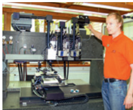
Lasereinsatz für Rückseitenkontaktierung
